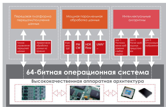
Структура ультразвуковой платформы mQuadro
